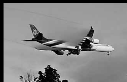
September, morgens um 8 Uhr, Zürich Flughafen. Anflug. Hohe Feuchtigkeit der komprimierten Luft erzeugt Wirbelschleppen, die das Flugzeug wie einen Drachen aussehen lassen.
